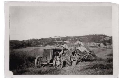
Associació Cultural "Baixa Segarra". Autor Robert Balcells. "Lligadora d'en Marsal, que fou la primera a Sta. Coloma de Queralt. La lligadora era l'estri que es feia servir per ligar les garbes i poder-les portar a l'era. Treball agrícola vinculat al procés de collita del blat, també conegut com "les feines de segar i batre". Santa Coloma de Queralt (Conca de Barberà), 1926
